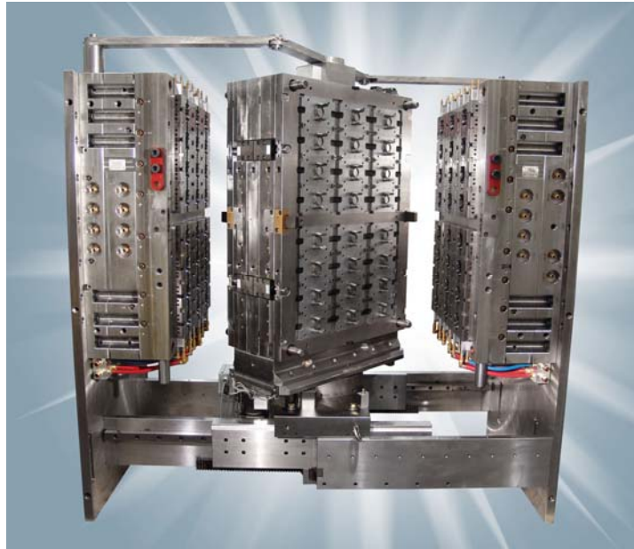
Mehrkomponenten-Werkzeug mit 24 Kavitäten und Drehvorrichtung für die automatisierte Verarbeitung von Substrat und TPE. Bild mit freundlicher Genehmigung der MGS Manufacturing Group.
