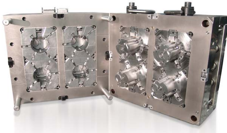
Insert-Form mit vier Kavitäten für die Herstellung von umspritzten Teilen. Bild mit freundlicher Genehmigung der MGS Manufacturing Group.
