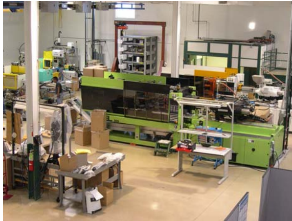
Die Insert-Technik hat den Vorteil, dass herkömmliche Einkomponenten-Spritzgießanlagen eingesetzt werden können. Bild mit freundlicher Genehmigung von Matrix Tooling, Inc
